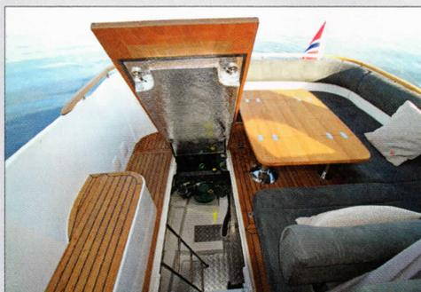
Un premier accès à la salle des machines, sous le cockpit, permet de procéder à l'entretien courant.
