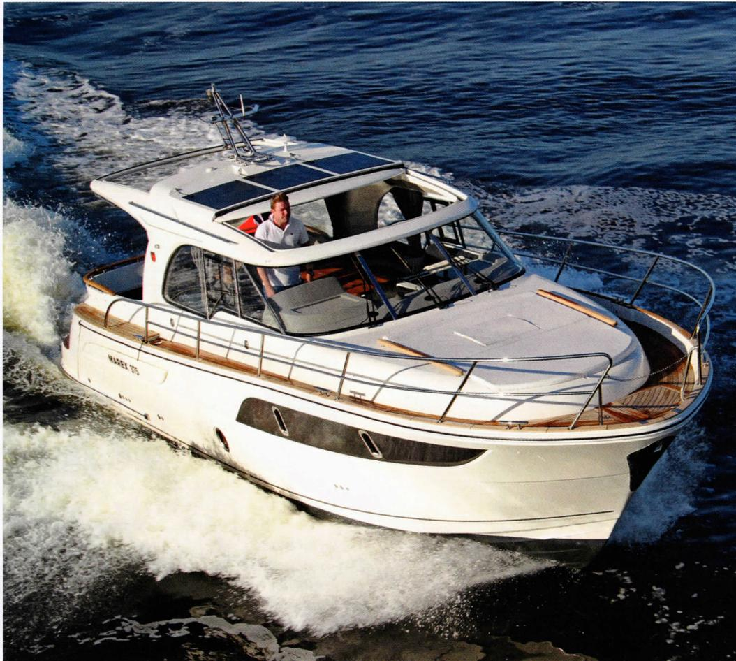
La carène, entièrement planante, passe dans le clapot de manière confortable. Elle se montre agile malgré un déplacement de près de huit tonnes.
