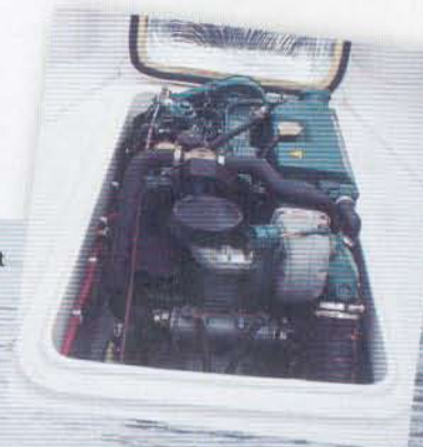
Motoren er højsileret med blandt andet "sound-killer" maling.
